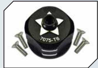
Art.Nr.: GPMSLE011BK GPM Aluminium 7075-T6 Diff-Gehäuse v/h schwarz
