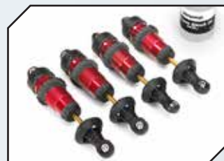
Art.Nr.: TRX5460R GTR Dämpfer Alu rot mit TiN Kolbenstange
