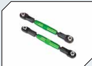
Art.Nr.: TRX3643G TRAXXAS L/R Spurstange Alurohr grün 83mm hinten
