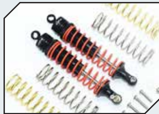
Art.Nr.: GPMRUS4102RBKOR GPM Aluminium Dämpfer hinten 102mm schwarz
