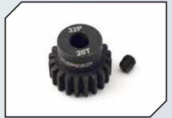
Art.Nr.: HSPX220 H-SPEED Motorritzel 20Z 32dp (M0.8) für 5mm Welle
