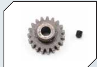
Art.Nr.: RRP1219 Robinson Motorritzel 19Z Modul 1.0 Extra Hart für 5mm Welle
