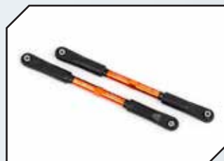
Art.Nr.: TRX9548T TRAXXAS Alu Sturzstangen hinten 144mm orange mit Kugelfannen
