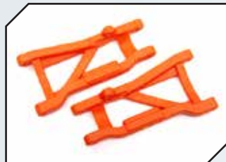
Art.Nr.: TRX2555T TRAXXAS Heavy Duty Querlenker hinten orange (kaltes Wetter)
