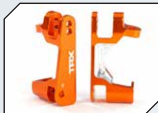
Art.Nr.: TRX6832A C-Hubs 6061-T6 Alu orange eloxiert
