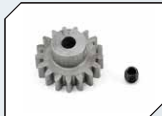
Art.Nr.: RRP1717 Robinson Motorritzel 17 Zähne 32dp Absolute gehärtet
