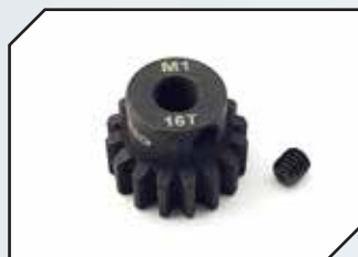
Art.Nr.: HSPX116 H-SPEED Motorritzel 16Z Modul 1.0 für 5mm Welle
