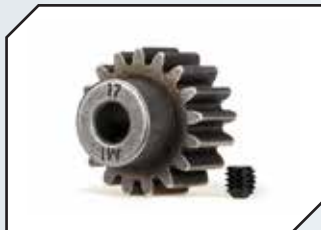
Art.Nr.: TRX6490X TRAXXAS Motorritzel 17Z Modul 1.0 Stahl für 5mm Welle
