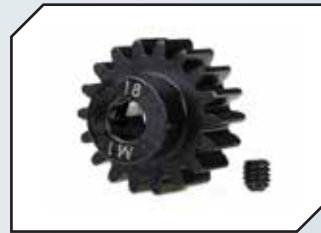
Art.Nr.: TRX6491R TRAXXAS Motorritzel 18Z Modul 1.0 Extra hart Stahl für 5mm Welle
