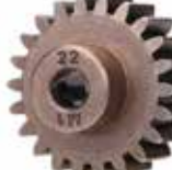
Art.Nr.: TRX6495X TRAXXAS Motorritzel 22Z Modul 1.0 Stahl für 5mm Welle
