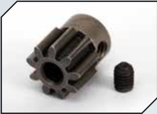
Art.Nr.: TRX6745 TRAXXAS Motorritzel 9 Zähne 32dp Stahl
