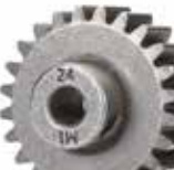
Art.Nr.: TRX6496X TRAXXAS Motorritzel 24Z Modul 1.0 Stahl für 5mm Welle
