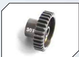
Art.Nr.: AM348030 ARROWMAX Motorritzel 30 Zähne 7075 HARD 48dp (nur BL)
