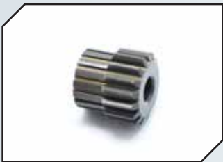
Art.Nr.: AM348016 ARROWMAX Motorritzel 16 Zähne 7075 HARD 48dp
