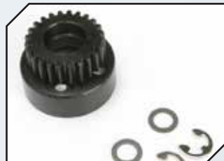
Art.Nr.: TRX4124 TRAXXAS Kupplungsglocke 24 Zähne Stahl (nicht für 58 HZ)
