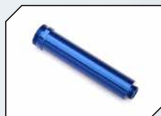
Art.Nr.: TRX8462X TRAXXAS Alu-Dämpfergehäuse GTR 77mm blau (ohne Gewinde)
