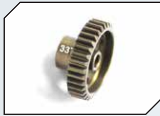
Art.Nr.: AM348033 ARROWMAX Motorritzel 33 Zähne 7075 HARD 48dp (nur BL)
