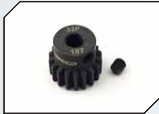
Art.Nr.: HSPX218 H-SPEED Motorritzel 18Z 32dp (M0.8) für 5mm Welle
