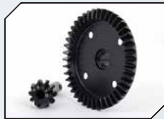
Art.Nr.: TRX9579R TRAXXAS Tellerrad und Triebfling Diff gefräst vorn oder hinten
