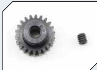
Art.Nr.: RRP1322 Robinson Motorritzel 22 Zähne hart beschichtet 48dp
