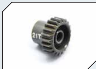
Art.Nr.: AM348021 ARROWMAX Motorritzel 21 Zähne 7075 HARD 48dp
