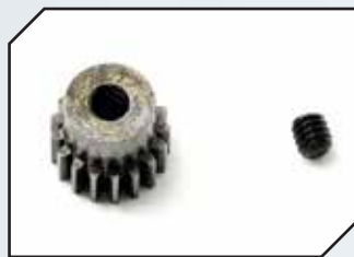
Art.Nr.: RRP1417 Robinson Motorritzel 17 Zähne Absolute gehärtet 48dp
