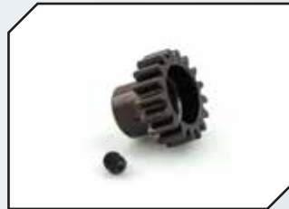
Art.Nr.: AM601017 ARROWMAX Motorritzel 17Z Modul 1.0 Stahl für 5mm Welle
