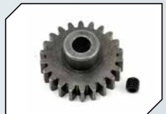
Art.Nr.: RRP1222 Robinson Motorritzel 22Z Modul 1.0 Extra Hart für 5mm Welle
