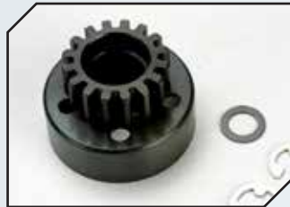
Art.Nr.: TRX5215 Kupplungsglocke 15 Zähne Modul 1.0
