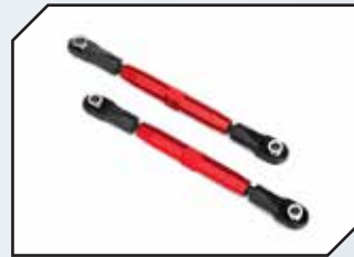
Art.Nr.: TRX3644R TRAXXAS L/R Spurstange Alurohr rot 73mm hinten
