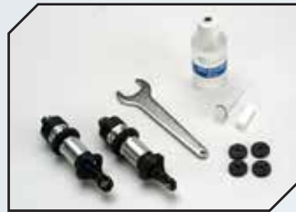
Art.Nr.: TRX5460 TRAXXAS GTR Dämpfer Alu silber mit TiN Kolbenstange (2 Stk.)
