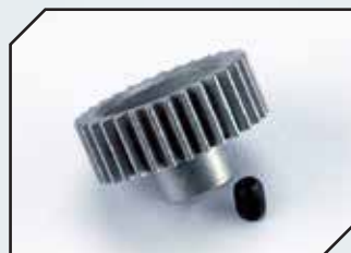
Art.Nr.: TRX2431 TRAXXAS Motorritzel 31 Zähne 48dp (BR ab 76 Hz/BL bis 83 Hz)
