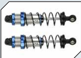
Art.Nr.: PRO6308-30 ProLine Pro-Spec Dämpfer vorn vormontiert
