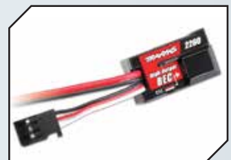
Art.Nr.: TRX2260 TRAXXAS High-Output BEC (komplett)
