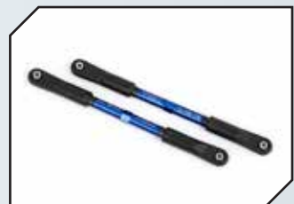
Art.Nr.: TRX9548X TRAXXAS Alu Sturzstangen hinten 144mm Alu blau mit Kugelfannen
